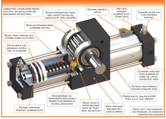
TYPICAL ACTUATOR CONSTRUCTION & FEATURES\*
